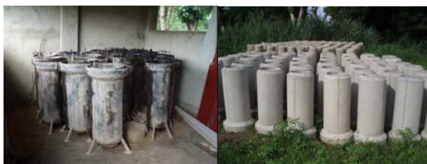
Figure 7: Des Moules (à gauche) et des tuyaux (à droite) en béton utilisés pour la construction du réseau des eaux usées dans le quartier Ewawu (Kara Togo, Août 2009)
